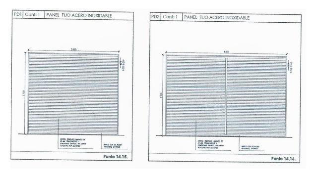
Se solicita por favor especificar sección de los caños de acero inoxidable a utilizar en los marcos de estos paneles. Indicar medidas finales de ancho y alto. Se requiere se aclare la sección de caño.
